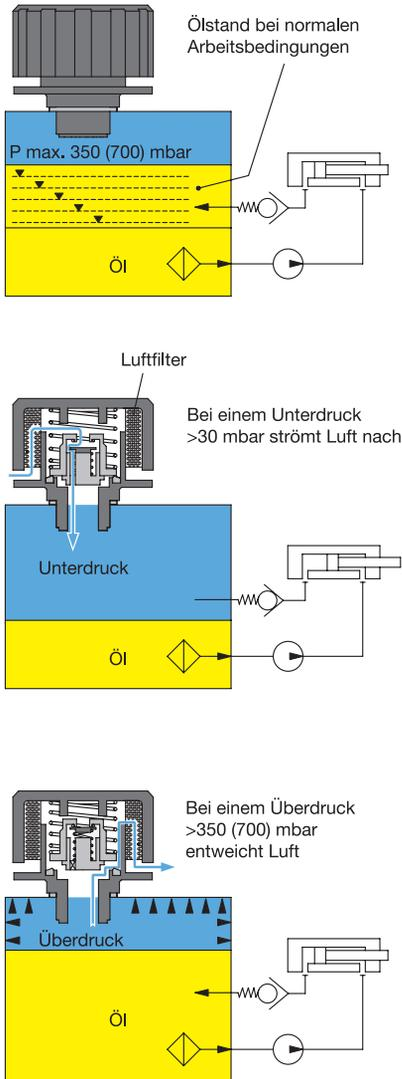
Belüftungsdeckel GN 774 mit Doppelventil werden in der Regel eingesetzt, wenn der Ölbehälter unter Druck steht, bei Unterdruck (sinkendem Flüssigkeitsstand) jedoch Luft von außen nachströmen muss.
