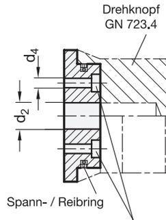
2 Bohrungen für Zylinderschraube ISO 4762
